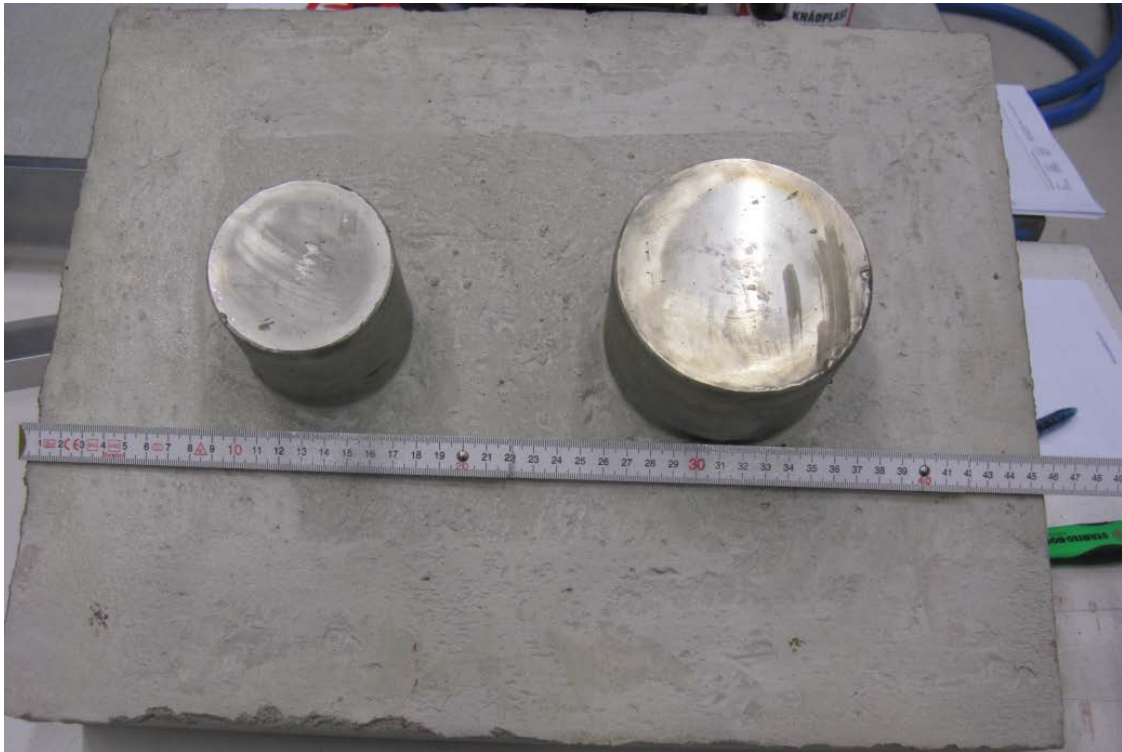
Bild 1: Provföremålets betongblock med två tätade rör ingjutna i centrum av blocket.
